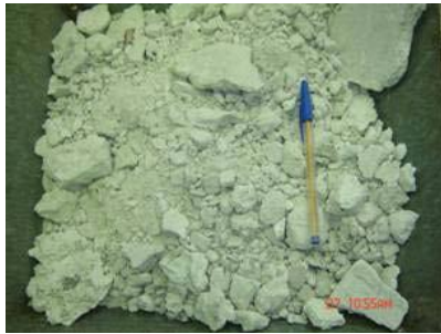
Figura 1: Yeso recuperado de aplicaciones húmedas (YH)
