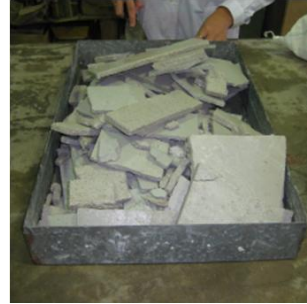
Figura 2: Yeso recuperado de placas laminadas (YS).
