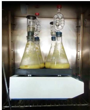
Figura 1: Sistema experimental utilizado para ensayos SSF.
