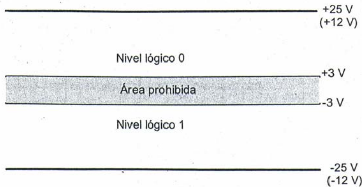
Figura 42. Niveles de tensión RS 232.
