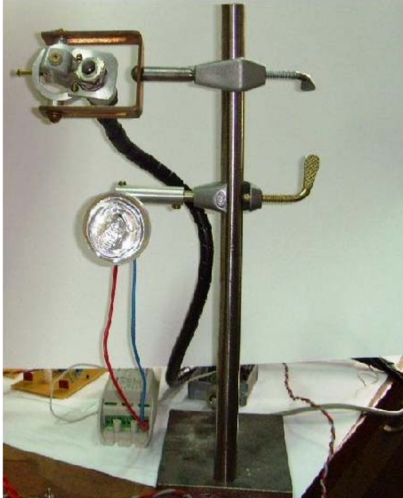
Foto 4. Sistema posicionador de la lámpara y el pirómetro.
