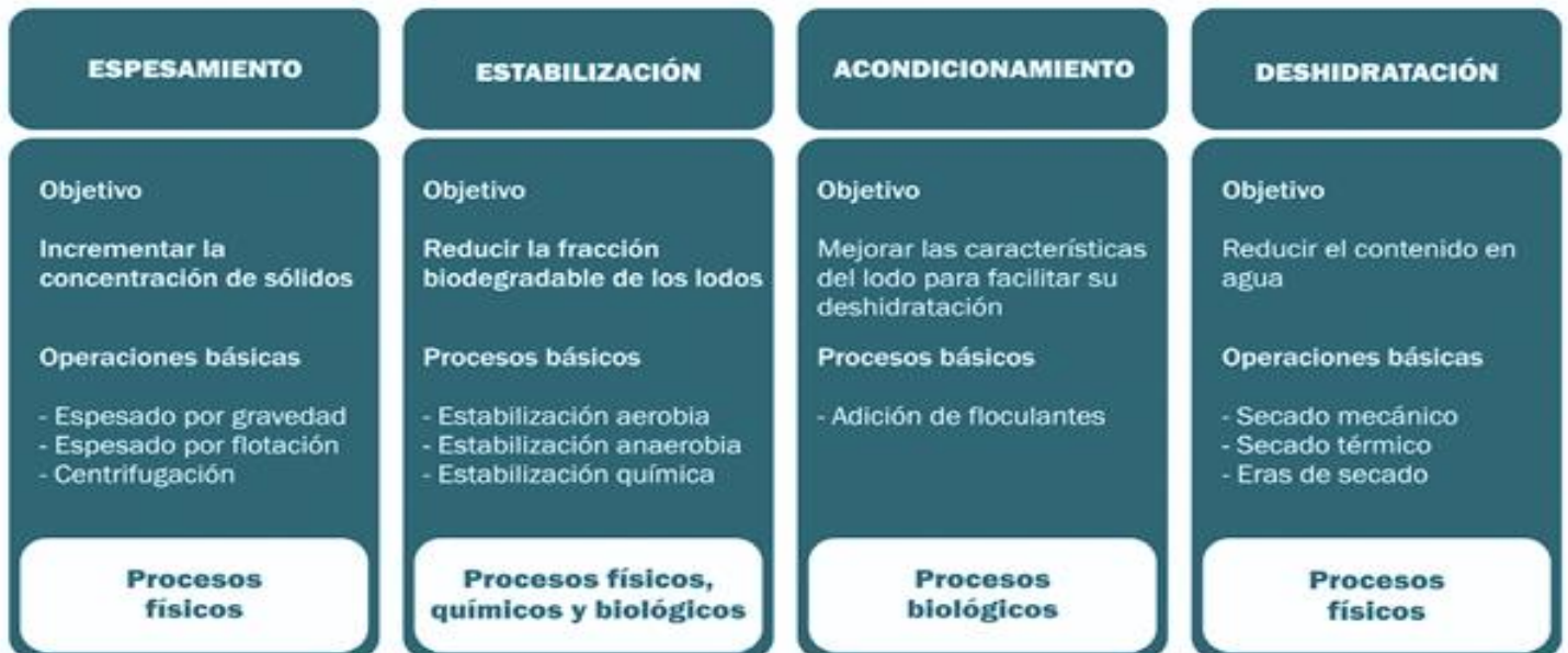
Figura 17 – Tratamiento de la línea de lodos (CENTA, 2008)
