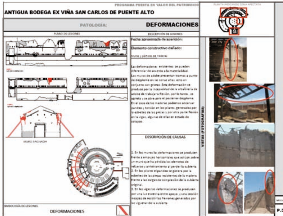
Fig. 25 Ficha de patologías presentes en la bodega
